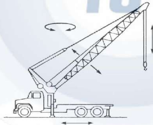
GRÚA MONTADA SOBRE CAMIÓN COMERCIAL Pluma Celosía
