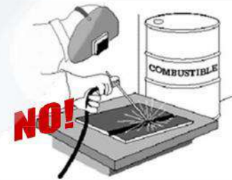
No soldar cerca a materiales combustibles o inflamables no protegidos.
