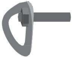
Pernos de Anclaje
