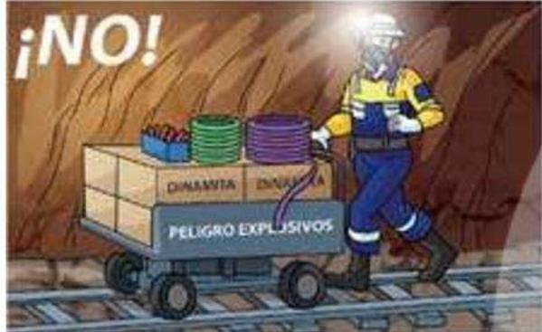
No transportarlos en locomotoras, ni permitir que se contacten con líneas eléctricas activas como la del trolley.
