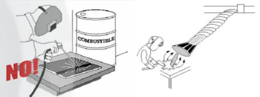
**NO!** No soldar cerca a materiales combustibles o inflamables no protegidos. Cuando el área de soldadura contiene gases, vapores o polvos, es necesario una ventilación adecuada y cubrir con material resistente al fuego
