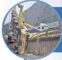
*De pérdida de estabilidad (de la carga, de la máquina o de sus elementos).*
