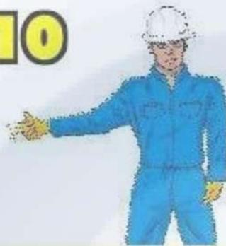
**ELEVAR EL BOOM Y BAJAR LA CARGA:** Brazo extendido, pulgar señalando hacia arriba, abrir y cerrar los dedos para indicar el movimiento deseado.
