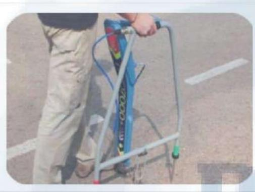
**Equipos para detección de cables y tuberías**
