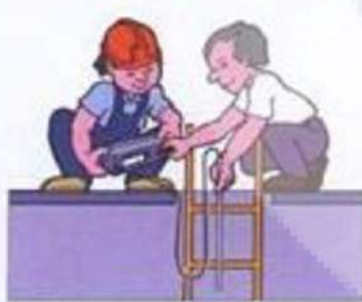
Limpieza, medición y evaluación del ambiente interior, por personal cualificado, para determinar su peligrosidad.
