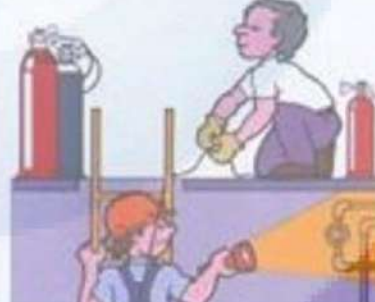
Entrada en las condiciones establecidas y con medios y equipos adecuados (ventilación suficiente, protecciones personales, escalera, cuerda de salvamento sujeta desde el exterior, etc.).
