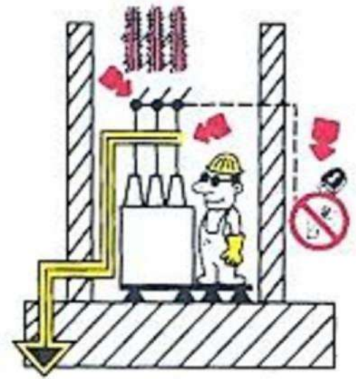
4. Poner a tierra y en cortocircuito.
