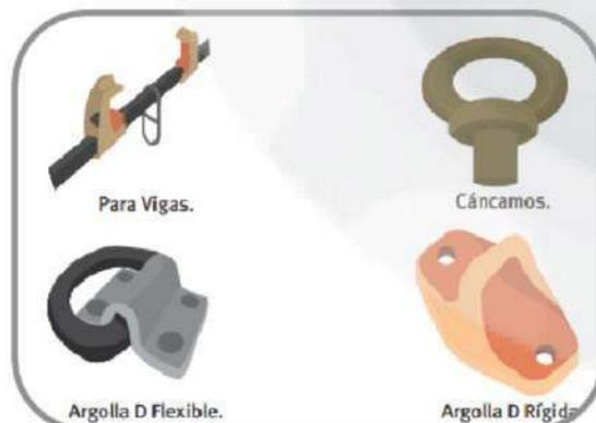
**IP** Utilice siempre conectores de anclaje
