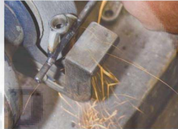
El esmerilado Usa una rueda de esmeril que gira a alta velocidad para cortar el metal.
